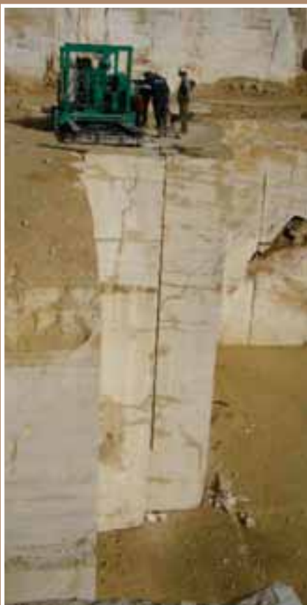
Vertikalschnitt mit der Schrämmaschine im Steinbruch ANGELICA
