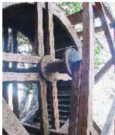
Das Tretrad wurde von ein oder zwei Mann bedient.
