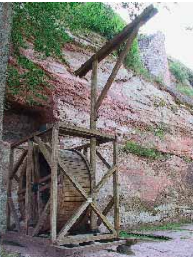
Das Tretrad wurde von ein oder zwei Mann bedient.
