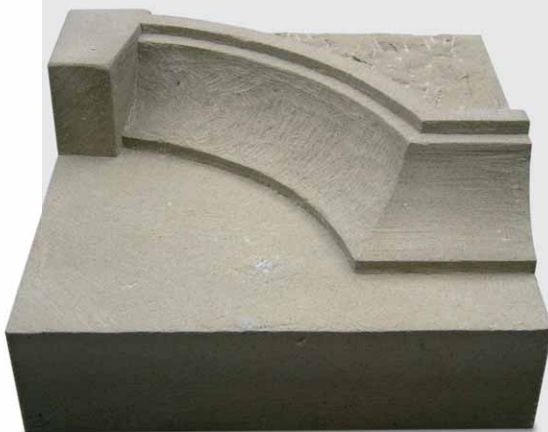
Steinmetzarbeitsprobe »Bogenprofil mit Schlusstein«, Sandstein
