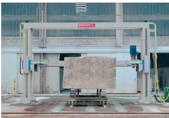
Bild 1: Gesamtansicht der SAWTECH 4000/1 mit 4000 mm nutzbarer Sägelänge
