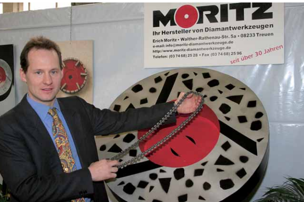
Bild 4: Gregor Moritz präsentiert die neue Diamantkette mit Diamantsegmenten auf jedem Kettenglied, die als Meterware für alle Kettensägen und Schwertlängen verwendet werden kann.
