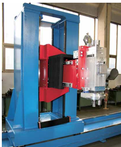
Bild 2: Modifiziertes Bearbeitungszentrum SPSBZ als 2-Tischanlage für die Bearbeitung keramischer Erzeugnisse
