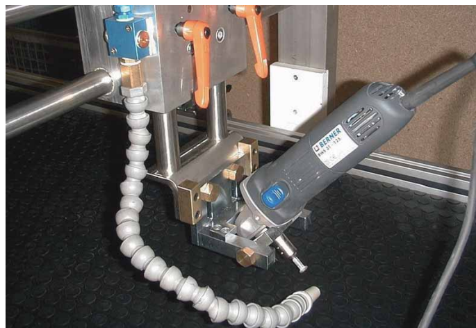
Bild 4: Als Antrieb dienen handelsübliche Winkelschleifer.
