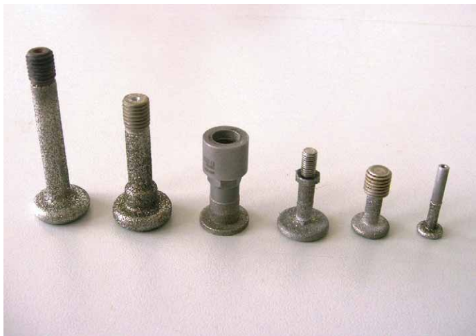
Bild 3: Galvanisch belegte Diamantwerkzeuge mit unterschiedlichen Aufnahmen für verschiedenartige Materialien
