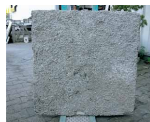
Verbund Monokornmörtel zur Platte (Rückseite)
