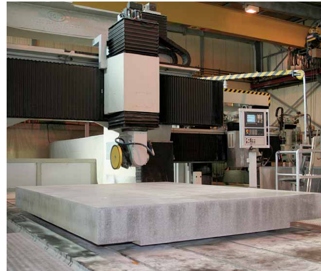
Bild 2: Zweiständer-Führungsbahnschleifmaschine mit einem Arbeitsraum von 8 000 mm x 4 200 mm x 1 250 mm und einem aufgebänkten Werkstück mit einer Oberseite von 3 000 mm x 3 800 mm
