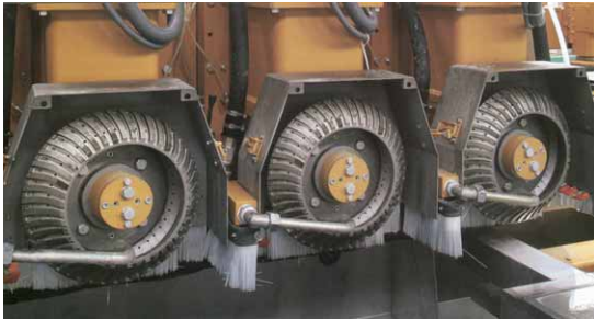
Bild 8: Fräseinheit der GOLDENGROOVE CTV3 von Breton
