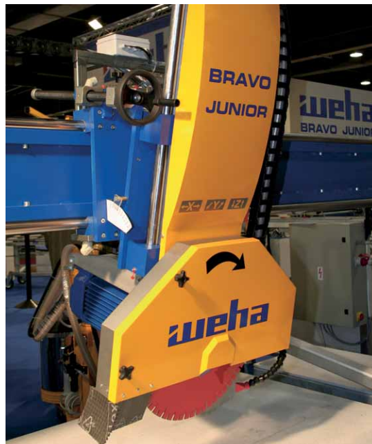
Bild 2: Brückensäge BRAVO Junior von weha mit von Hand schwenkbarem Vertikalsupport
