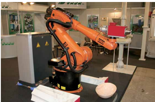
Bild 6: KUKA-Roboter mit angebauter Bearbeitungseinheit (Motorspindel, rot) auf dem Messestand von SABA
