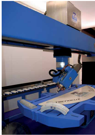
Bild 4: 5-Achsen-CNC-Brückensäge Cartesia von C.M.S. Brembana
