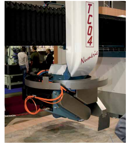
Bild 5: Brückensäge TC 04 von Thibaut mit getrennt angeordnetem Spindeltrieb
