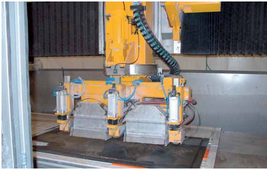
Bild 7: Fräseinheit der V-Grooving Maschine LVG DT von Löffler Maschinenbau
