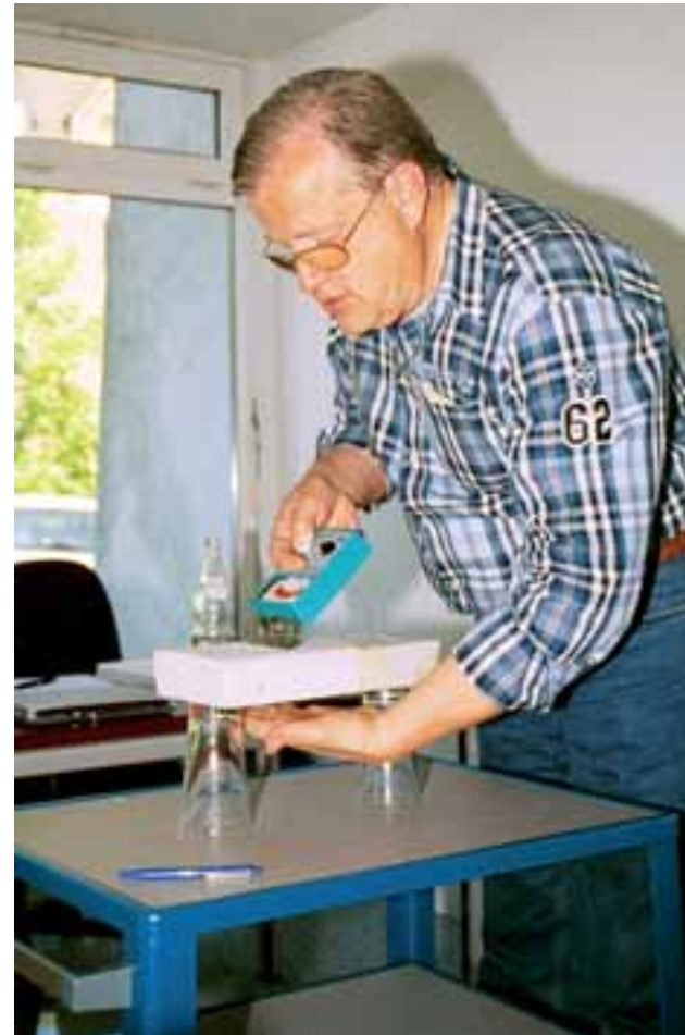
Walter Denzel demonstriert das Feuchtigkeitsmessgerät DNS-Hydrotest G 812.
