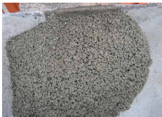
Monokornmörtel 2–8 mm im Freifallmischer
