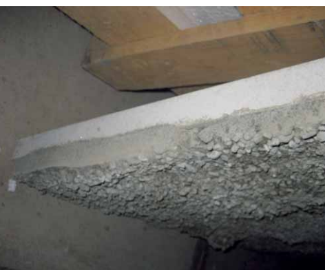
Haftverbund Monokorn / Naturwerkstein
