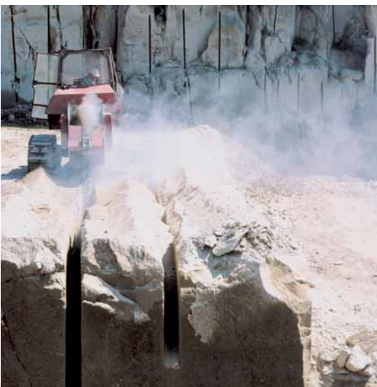
Die Firma Mendiger Basalt hat eine neue und schnelle Abbautechnik entwickelt: Mittels einer auf Ketten fahrenden Fräse aus dem Straßenbau werden Furchen in den Tuffstein gegraben.
