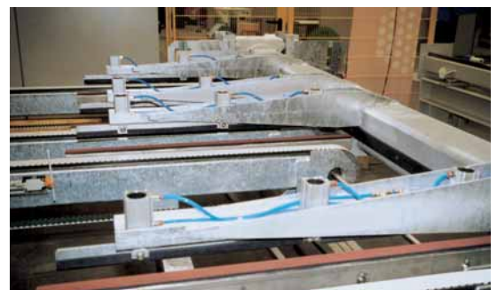
Bild 4: Wendestation mit pneumatischer Klemmung der Plattenerzeugnisse
