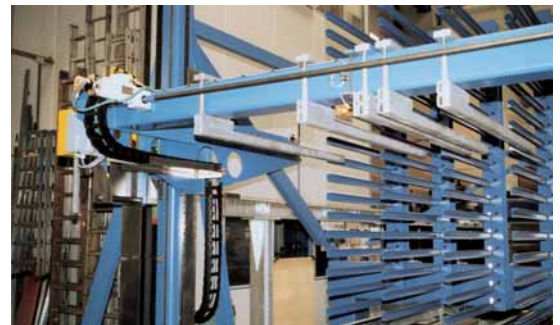
Bild 3: Werkstückspeicherregal mit Regalbediengerät
