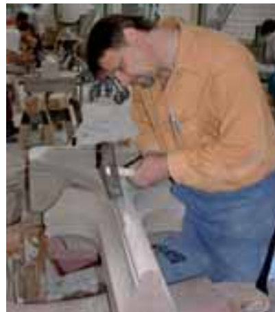
Fertigstellung des Rundstabs mit einem Zahnhammer
