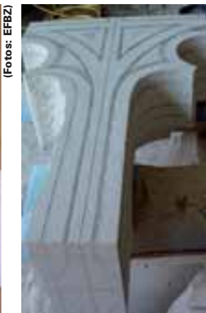
Werkstück mit angeschriebenen Profilkanten und Linien für das Plättchen am Rundstab
