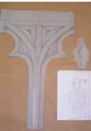
Anlegeschaablone für die Sichtseiten des Werkstücks
