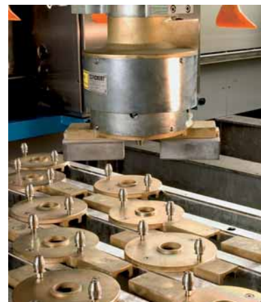
Bild 2: Werkzeugmagazin mit bis zu 18 programmierbaren Schleifteller-Plätzen bei Nutzung des 2-fach-Schleifkopfes S2h (Option)
