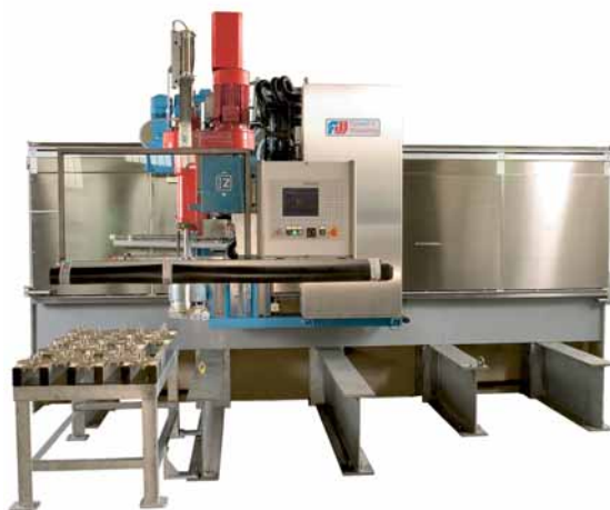
Bild 1: Gesamtansicht des Schleif- und Polierautomaten ASP 160 W-T mit vorstehenden Stützfüßen für den Bänkeaufbau
