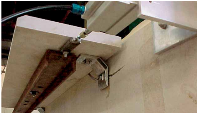
Abb. 8: Bauteilversuch einer Leibungsplatte
