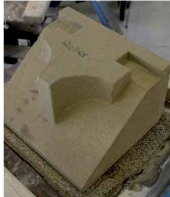
Steinmetzarbeitsprobe »Gewändeaufstand« von Stephanie Keller, UDELFANGER SANDSTEIN
