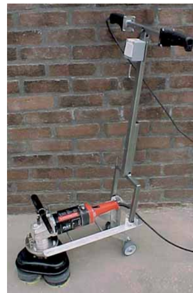
Bild 2: Fahrgestell zur bequemen Handhabung der Trimax-Dreischeibenmaschine
