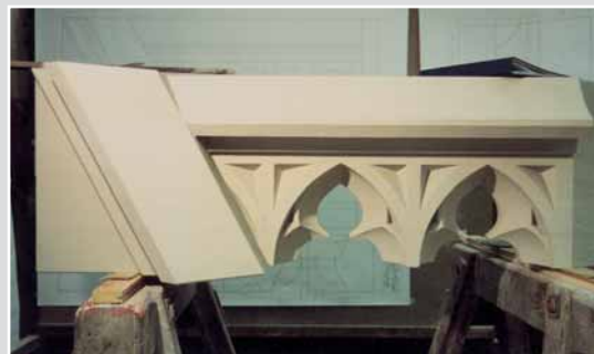
Maßwerkbrüstung von Denis Leicht aus Esslingen; HAHNBRUCH SANDSTEIN
