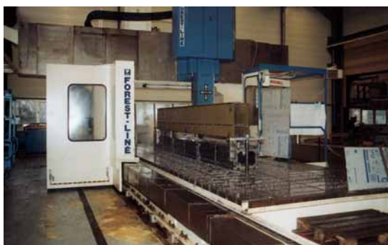
Bild 1: CNC Metallbearbeitungszentrum FOREST-LINE mit Werkzeugmagazin MODUMILL
