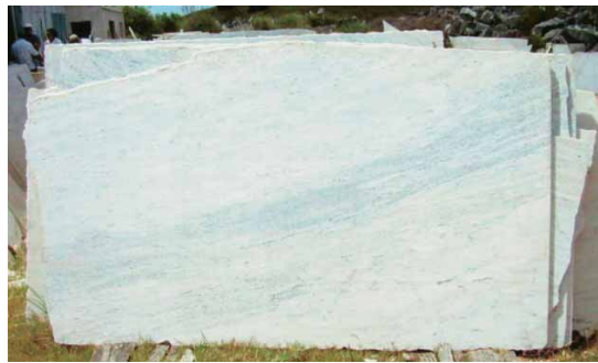
Steinbruch des grünlichweißen Silikatmarmors PEARL WHITE mit Kontakthof zum Granit rechts im Bild und Rohtafel mit typischer Farbkomposition
