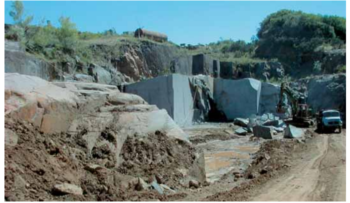
Blick in das Doleritvorkommen. Die begleitenden Hüllengesteine sind stark verwitterter Orthogneis; die Abbauhöhe liegt derzeit in zwei Etagen bei etwa 10 m.
