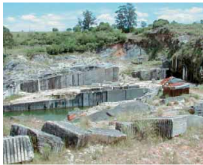
Steinbruch des grünlichweißen Silikatmarmors PEARL WHITE mit Kontakthof zum Granit rechts im Bild und Rohtafel mit typischer Farbkomposition
