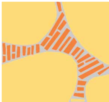
Zwickelfüllung und Grundbelag sind in verschiedenen Steinen mit unterschiedlichen Farben ausgeführt.
