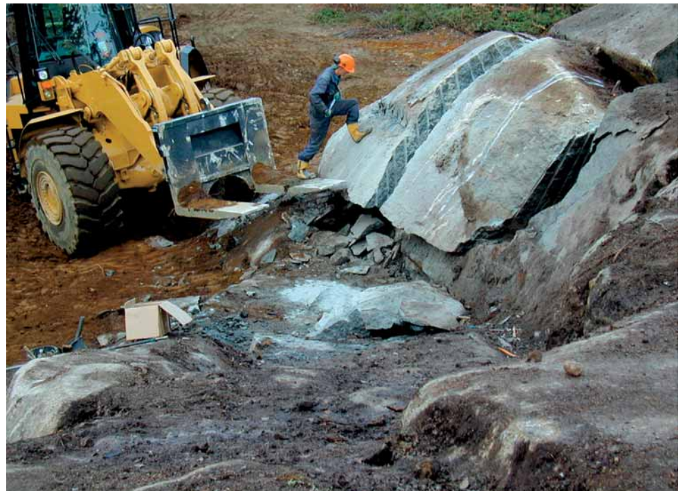
Vor der Erschließung jedes neuen Steinbruchs wird durch eine Probegewinnung von einigen hundert Kubikmetern die Abbaubarkeit des Gesteins ermittelt.
