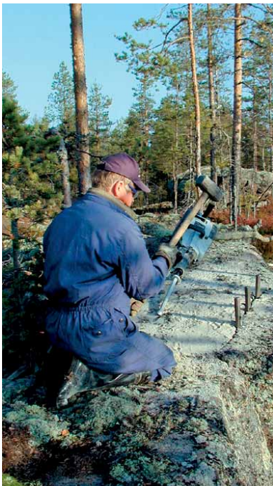
Gesteinsprobenentnahme mit Hilfe von Spaltkeilen
