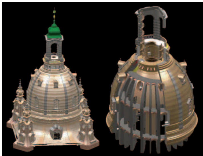
3-D-Planung der Hauptkuppel: Kuppelanlauf, Treppenturmspitzen, Laterne
