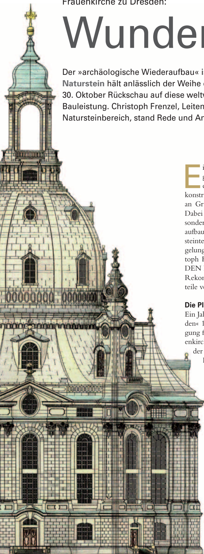
3-D-Planung der Hauptkuppel: Kuppelanlauf, Treppenturmspitzen, Laterne
