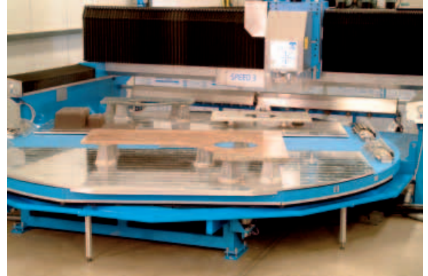
Bild 2: Die drehbare Werkstückspannfläche gestattet pausenloses Arbeiten.
