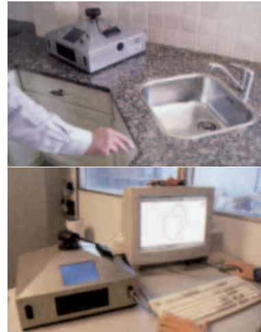
Bild 2: Aufmaß mit Taststift (oben) sowie Darstellung und Bearbeitung der Aufmaßdaten am PC
