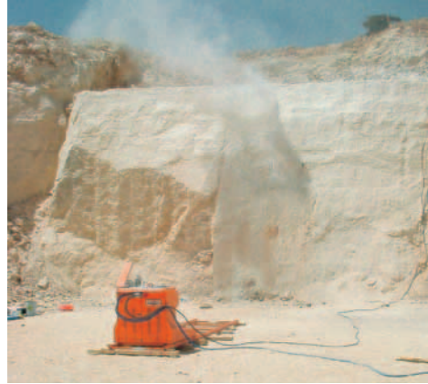
Bild 2: Trockenschnitt-Diamantseilsägen in einem ägyptischen Kalksteinbruch (Material: GALALA)
