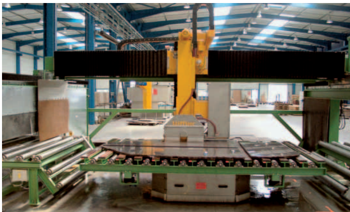
Bild 1: Gesamtansicht der Brückensäge TB 600 W mit programmgesteuertem Vakuumheber zwischen Aufgabe- und Abnehmerollenbahnen
