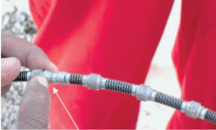
Bild 1: Trockenschnitt-Sägesaile mit Konus (Pfeil)
