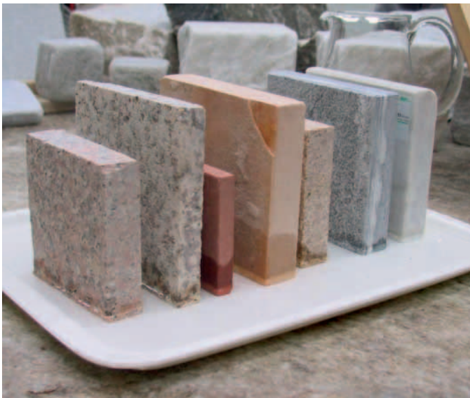
Auch innerhalb einer Gesteinsart kann die Wasseraufnahme der einzelnen Gesteinsorten stark differieren.
