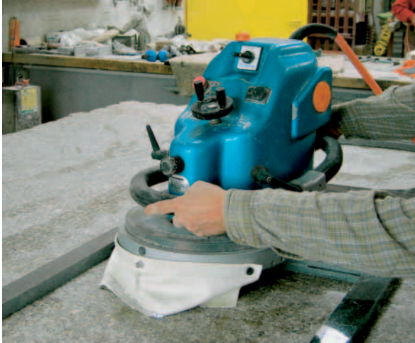
Bild 1: Einbringen horizontaler Einschnitte für die Eckverbindungen
