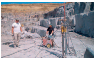
Ansetzen der Seilsäge im neuen Bruchbereich
