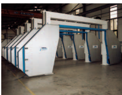
Bild 5: In Serie vormontierte Seilsägen der Baureihe MONOFILO
