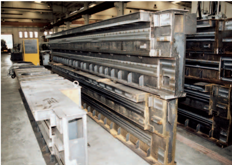
Bild 4: Spannungsfrei geglähte Stahlbaugruppen für Maschinengrundgestelle werden serienmäßig in Kooperation gefertigt.
