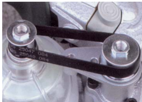
Bild 2: Riementrieb des Turbo-Saugrads
