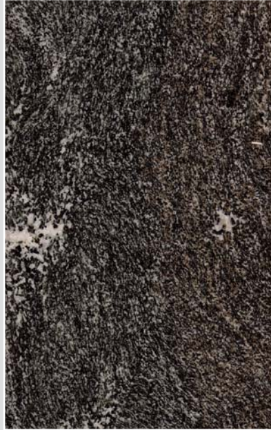
Der Amphibolgneis PORTO BRANCO ist angeblich das Pendant zu dem bekannten, ebenfalls dunklen Gneis PORTO ROSE mit rötlichen Feldspat-»Schnüren«. Er stammt aus dem gleichen Abbaubereich.
