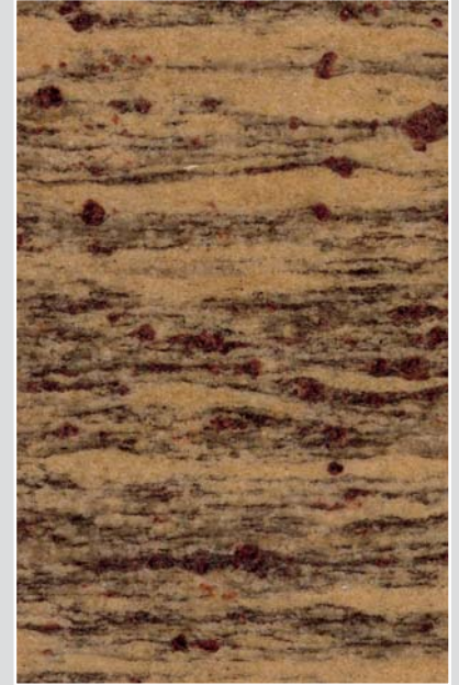
Ein indischer Granat-Gneis mit gelb-olivem Feldspat, Biotit-Flasern und großen, dunkelrotbraunen Granat-Kristallen.
