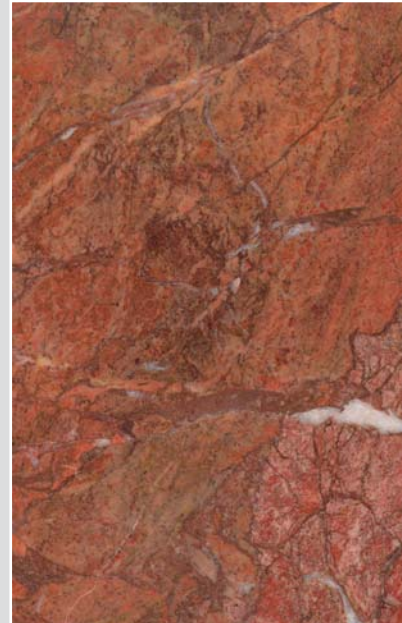
Die kanadische Kalkbrekzie CAPE BRETON BORDEAUX zeigt in manchen Partien Stromatolithen, also Kalkabscheidungen fossiler Blaugrün-Algen.
