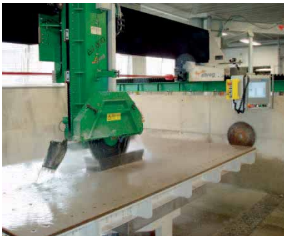
Bild 1: Brückensäge BS800 KomfortPlus
