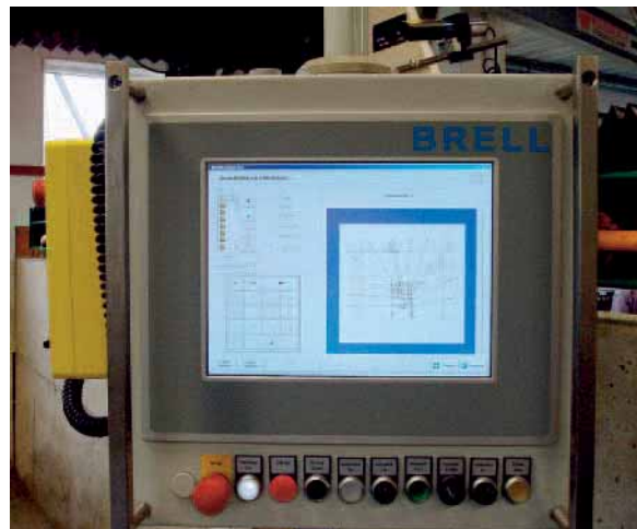
Bild 2: Optische Darstellung der Schnitteinteilung auf dem Touch-Panel
