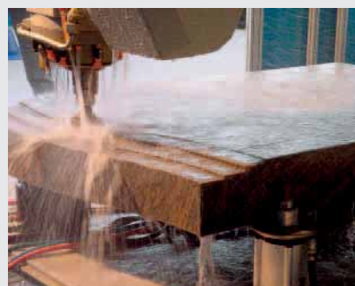
Bild 10: Fräsen einer Grabmalkontur
