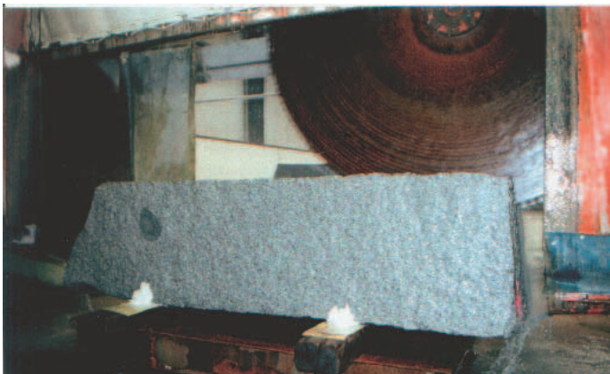
Bild 1: Blockkreissäge mit Blattdurchmesser 3000 mm, LAUSITZER GRANIT, Schnittlänge 3800 mm [2].
