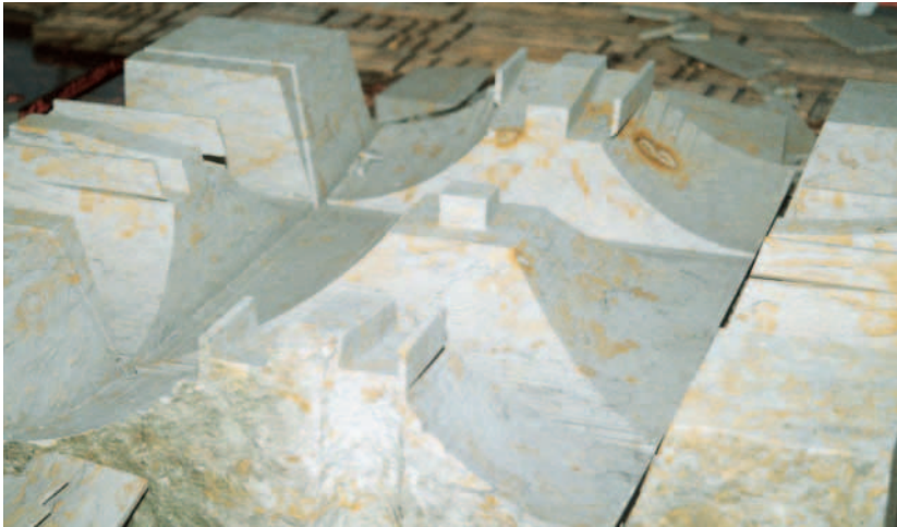
Bild 4: Nach Bearbeitung der vierten Seite werden die zerstörten Randstücke beseitigt.
