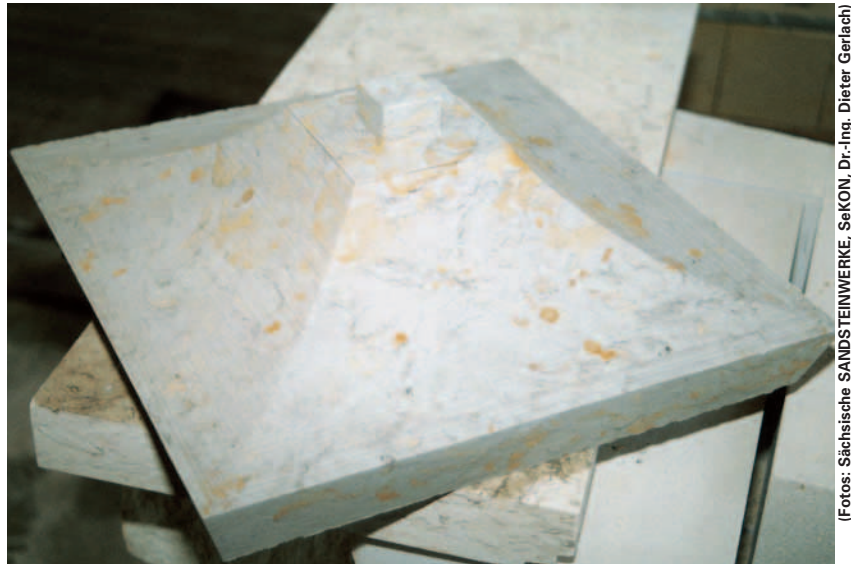
Bild 1: Komplett mit der Brückensäge M 712 CNC und dem Programm PROFIL hergestelltes vierseitiges Testprofil.
