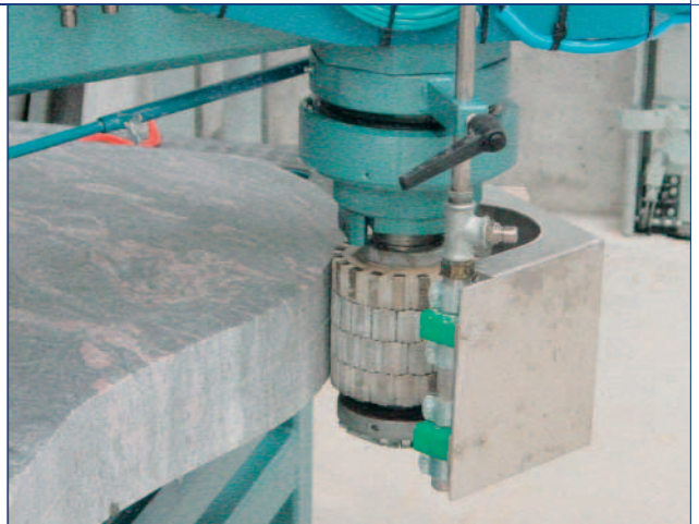
Einsatz eines segmentierten Fräswerkzeugs bei der Konturbearbeitung einer gewölbten Seitenfläche.
