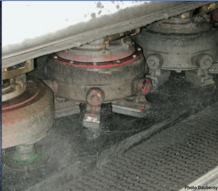
Bild 2: Schleif- und Polierwerkzeuge auf einem Mehrsupport-Schleif- und Polierautomaten.
