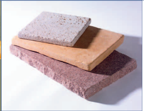
Bild 2: Im Trogvibrator künstlich gealterte Bodenplatten.
