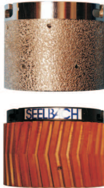
Vorfräserwerkzeug Korn 60 (oben) und Schleif- und Polierwerkzeug Korn 120 bis Korn 2 000.
