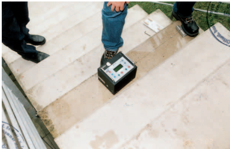
Bild 3: Messung des Gleitreibungskoeffizienten auf der dritten Stufe von oben.
