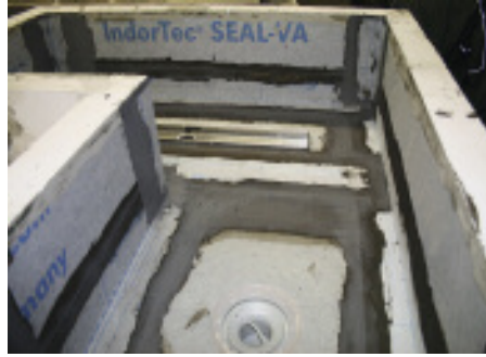
Prüfbecke der Folienabdichtung inkl. Bodenablauf und Duschrinne
