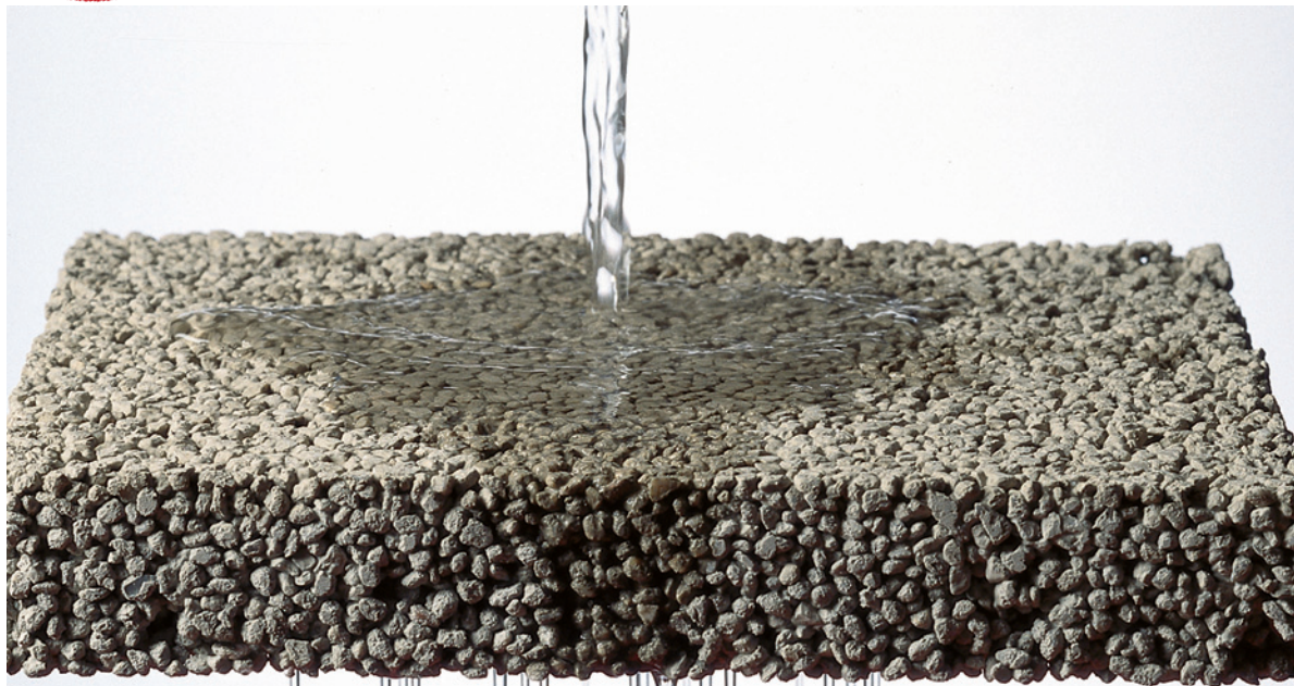
Der drainagefähige Monokorn-Spezial Estrich SCHÖNOX MSE
